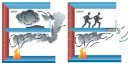
Bild 11: Direkterfassung von Brandrauch unterhalb von Galeriebereichen
