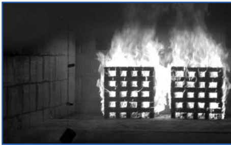
Brandversuch nach DIN 18 232-4: Lichtkuppel aus PMMA, Außenschale 3 mm, Innenschale 2 mm Brandlast: 48 kg Holz
